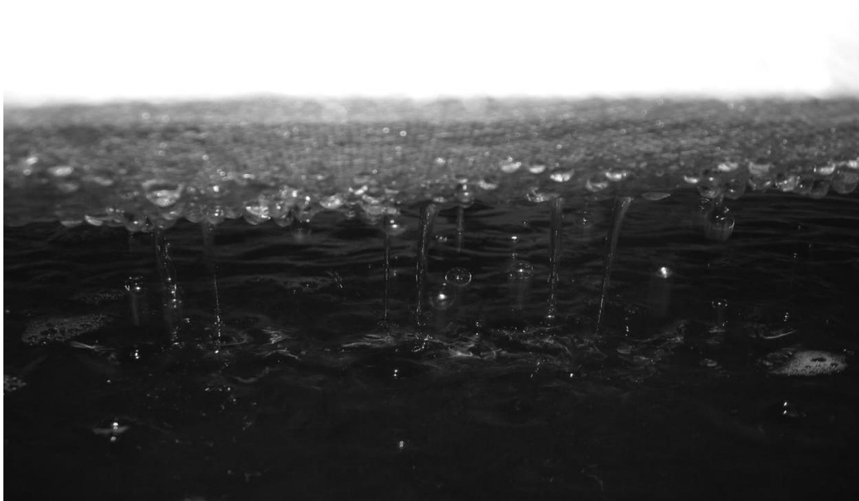
Рисунок 6 - Вода просачивающиеся через «Спанбонд» в процессе фильтрации
