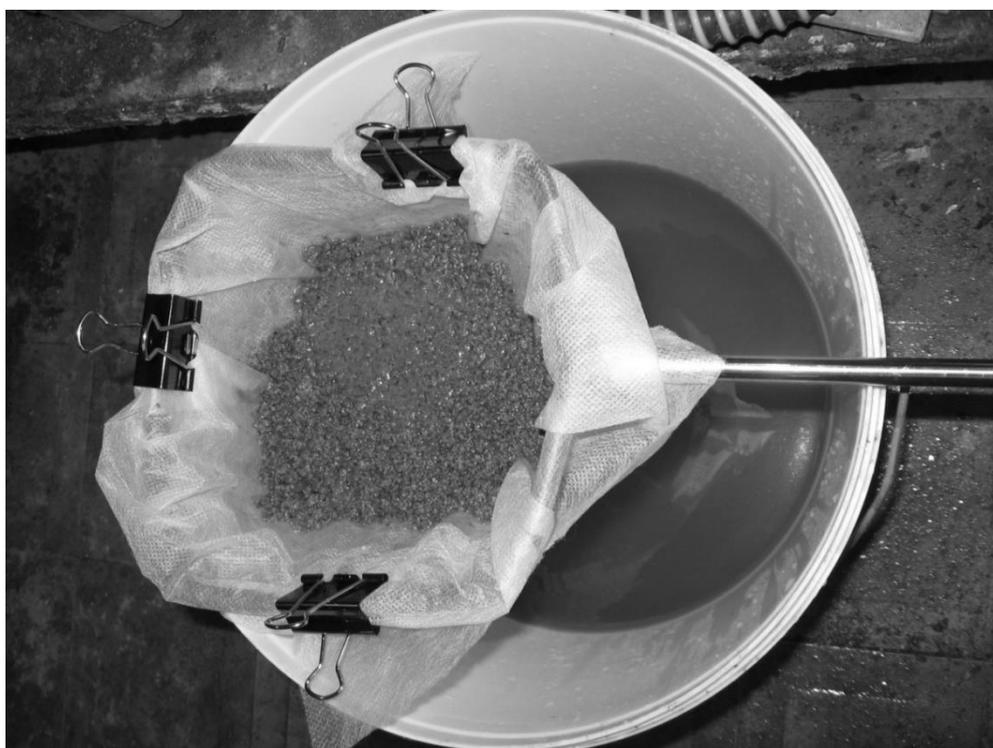
Рисунок 9 - Гравитационная фильтрация осадка на спанбонде
