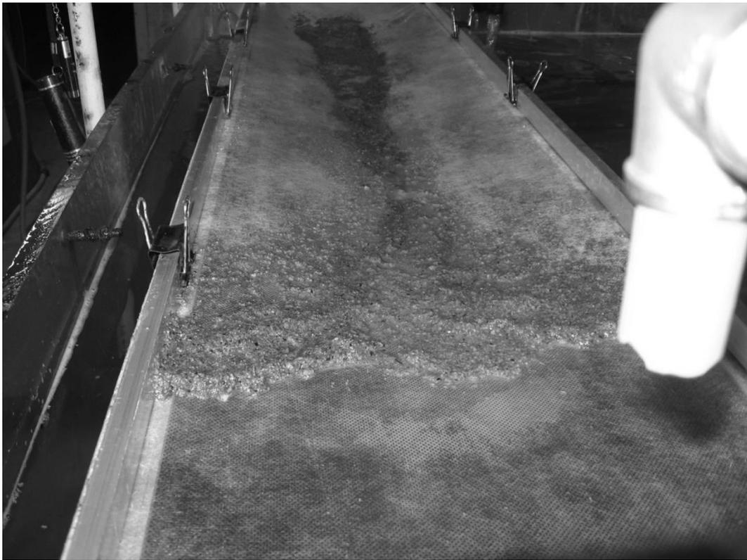
Рисунок 3 - Осадок из рыбоводной ёмкости на фильтрационном лотке
