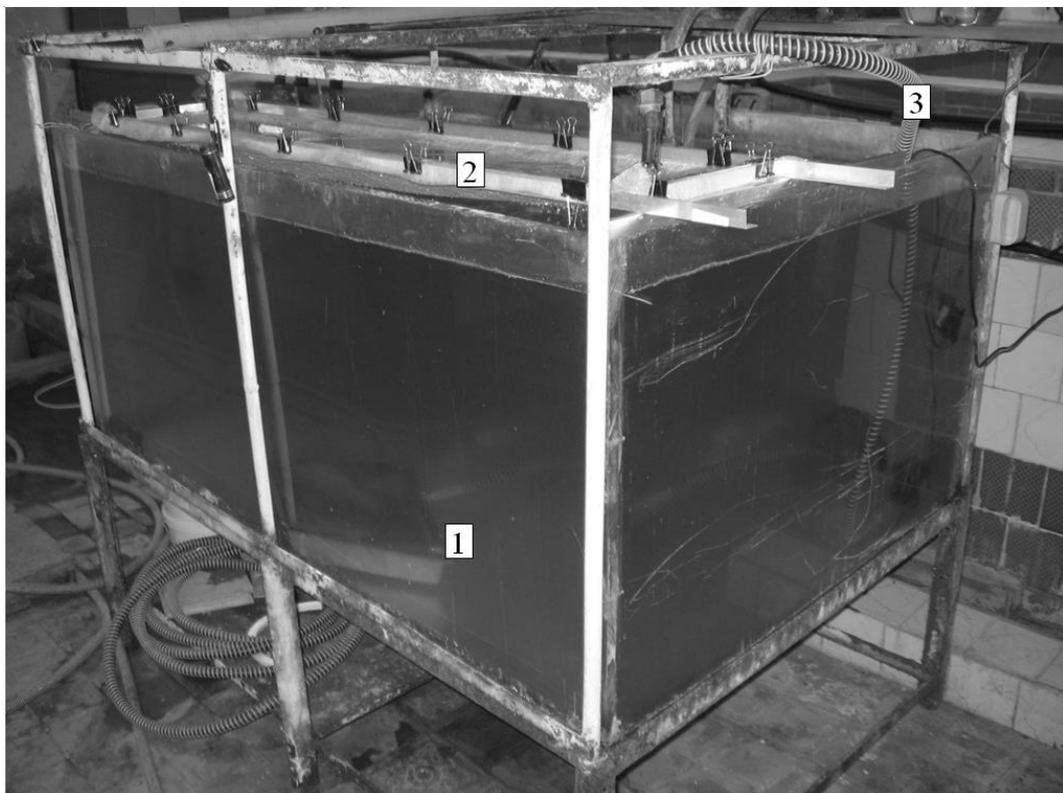
Рисунок 4 - Система фильтрации осадка из рыбоводной ёмкости.
